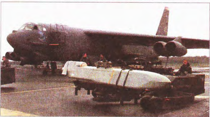
Работа эскадрильи технического обслуживания авиационного крыла В-52Н при выполнении операций по подготовке и подвеске КРВБ
